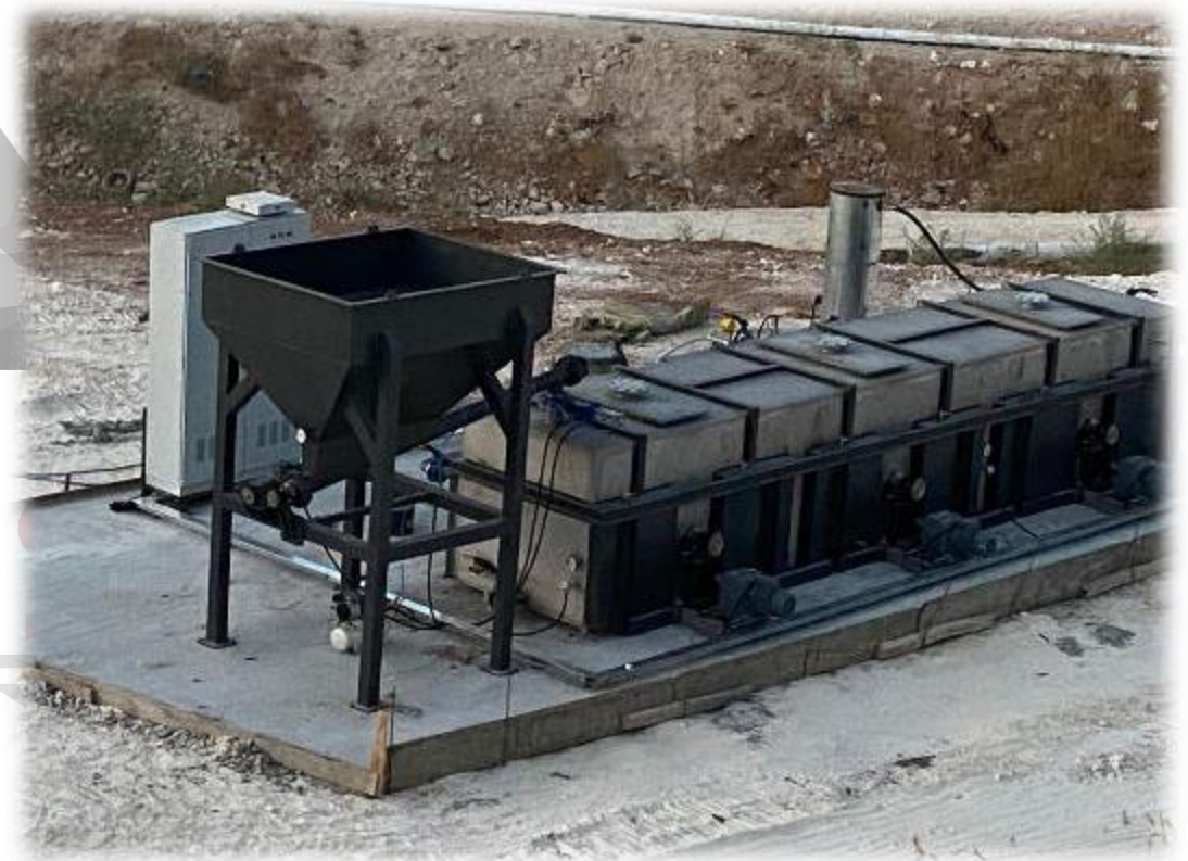
PLUG FLOW MINI DIGESTER
